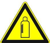
Druckgasflaschen sind nach den Vorschriften zu transportieren und täglich nach Arbeitsende aus dem Gebäude zu entfernen.
